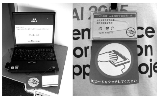
図 2 入室管理端末と RFID タグ付き名札カード
